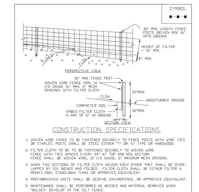
TYPICAL SILT FENCE DETAIL
