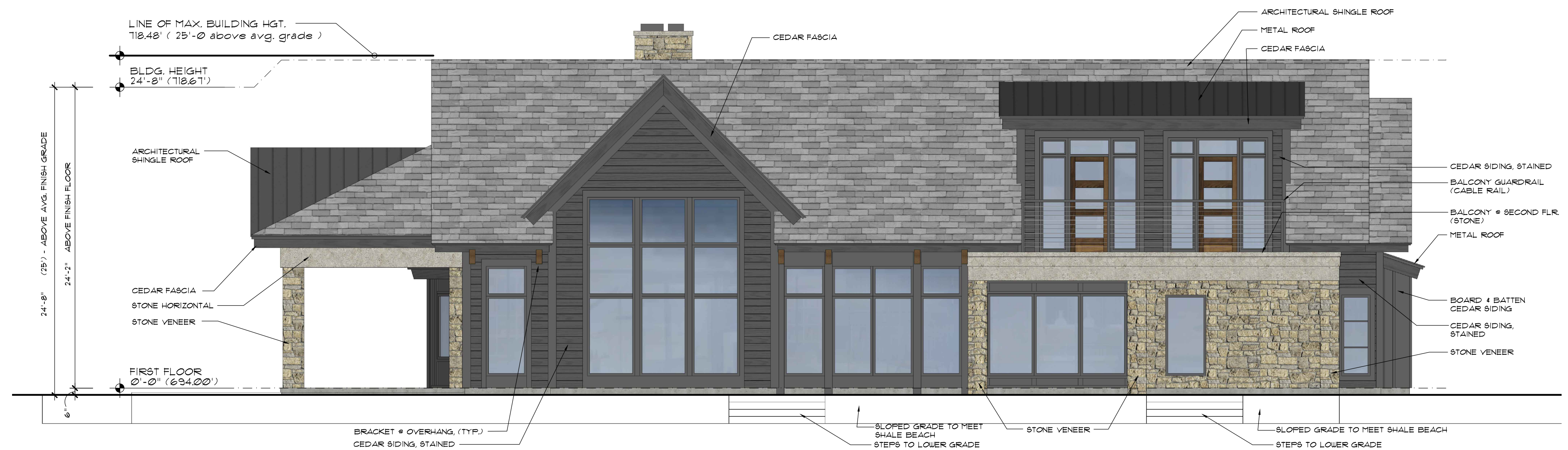
1 A2 WEST ELEVATION - LAKE SIDE SCALE: 3/16" = 1'-0"
